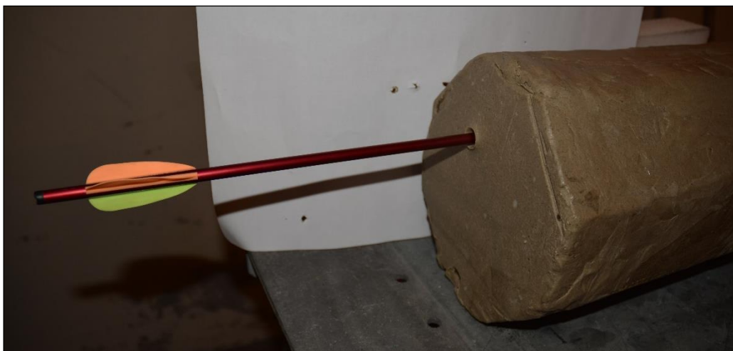
Obrázek 2: Zástřel šípem kuše délky 14“ HalfMoon ve zkušebním bloku vyrobeném z plastelíny (PL)
