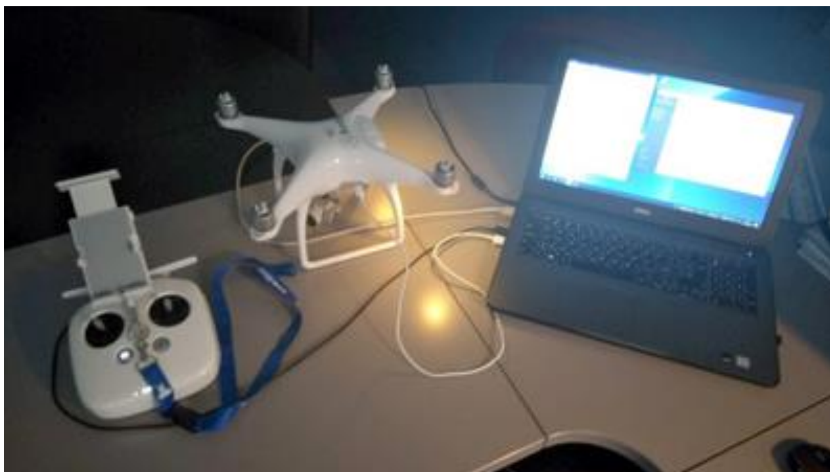
Obr. 21 Sestava dronu DJI Phantom 4 „AMBIS“ a kontroléru při kalibraci a aktualizaci firmware
